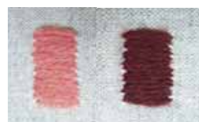
Выкраски стружками и экстрактом бразильского дерева по алюминиевой протраве
